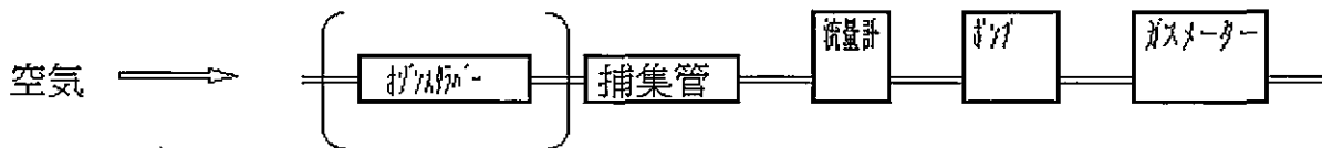
ホルムアルデヒドの試料採取装置の一例
